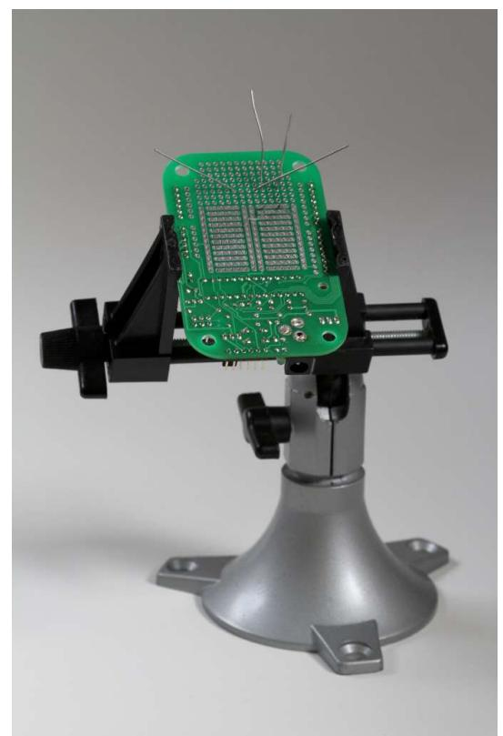
دست سوم: از این وسیله نیز می توان برای لحیم کاری بردهای کوچک و قرار داردن قطعه در مکان مورد نظر استفاده کرد.
