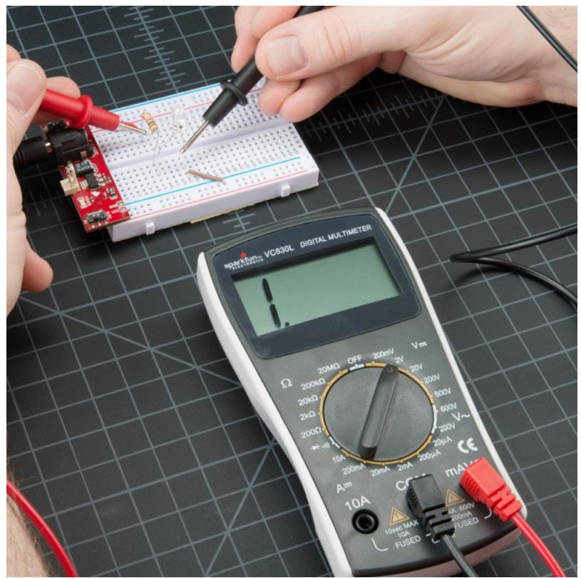
ابتدا پروب ها را به پایه های VCC و GND برد تامین توان متصل کرده و توان ورودی را که باید حدود 5V باشد اندازه گیری کنید.
