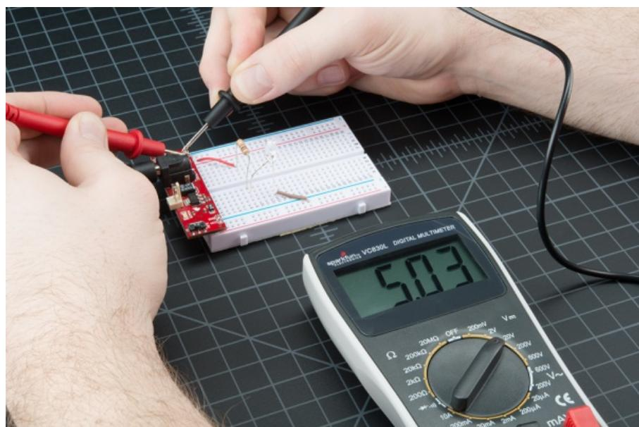
با استفاده از پروب ها می توانید ولتاژ هر نقطه از مدار را اندازه گیری کنید و بینید که هر قطعه از مدار به چه ولتاژی احتیاج دارد. با این کار شما در واقع دارید تحلیل گره انجام می دهید. حال بباید ولتاژ کلی مدار را اندازه گیری کنید، یعنی پروب ها را از یک طرف به پایه مقاومت و از طرف دیگر به پایه LED متصل کنید. این ولتاژ در واقع همان ولتاژ ورودی مدار یعنی 5V می باشد.
